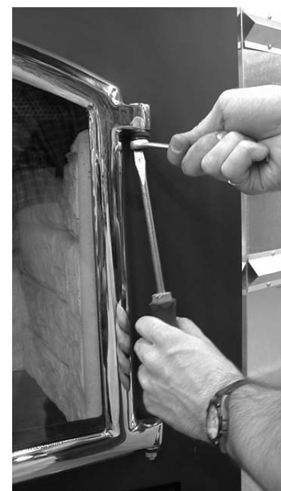
Figure 6 Ajustement des pentures de porte
